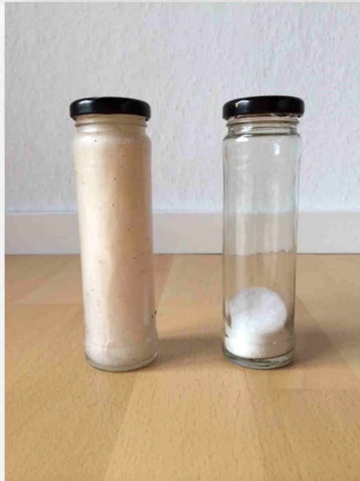
links das Duschpeeling, rechts das herausgefilterte Mikroplastik
